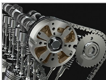
1,352cc vier cilinders in lijn motor met variabele
